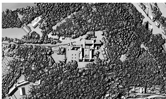
Figure 3: Ombrage du modèle numérique de surface (MNS) à l'exemple de l'Abbaye de Clervaux.
