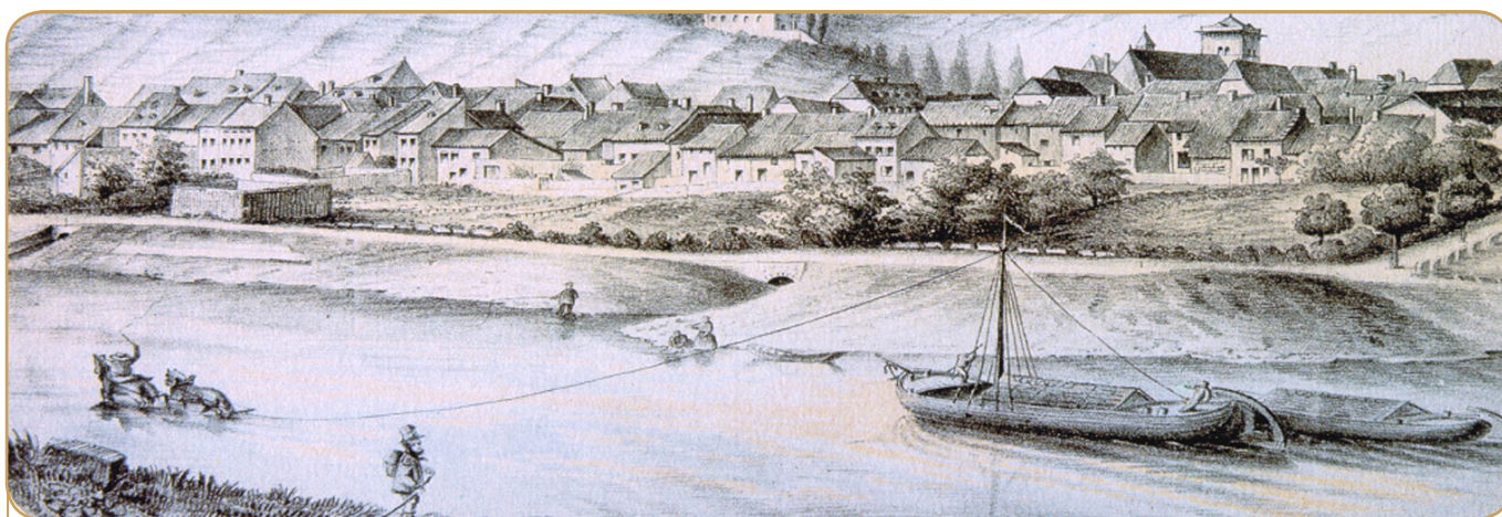
Convoi de halage remontant la Moselle au droit de Grevenmacher. On distingue un bateau moyen du type Caine et une espèce de nacelle connue en France sous le nom de champ-des-vignes et en Allemagne sous celui de Bohrnachen (Franz Heldenstein, vers 1850).
