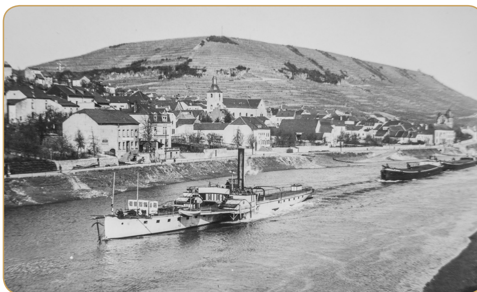
Bateau à vapeur «Prinz Heinrich» (55 x 11,70 m tirant d'eau 0,63 - 0,75 m, capacité 753 personnes, construit en 1895) remorquant des chalands en coque de fer devant Wormeldange (cliché vers 1920).
