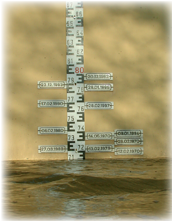
échelle limnimétrique avec référence aux crêtes de crue antérieures
