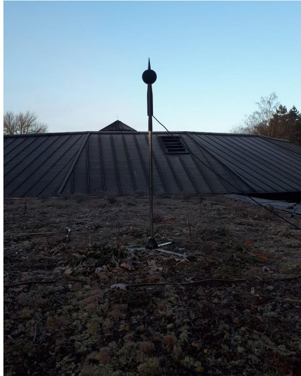
Image 8 : Positionnement du microphone sur toiture plate
