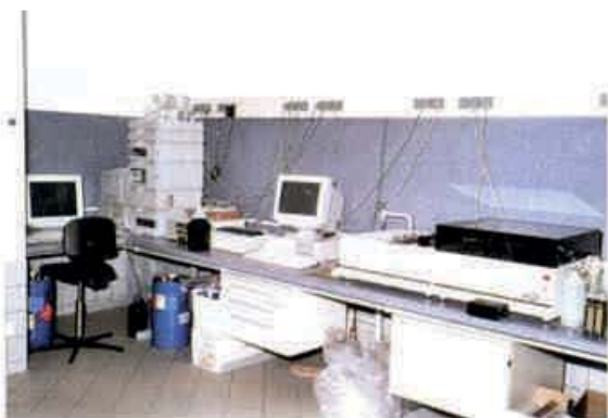
Automatisierte Restzucker- und schweflige Säurebestimmung
