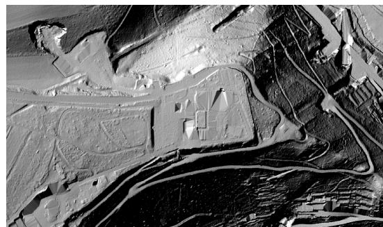
Figure 4: Ombrage du modèle numérique de terrain (MNT) à l'exemple de l'Abbaye de Clervaux.
