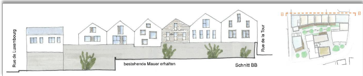
Abb. 12: Schnitt entlang der bestehenden Mauer der „Presbytère“ zur Darstellung der Integration der Bauweise der Reihenhäuser. Quelle: gap 2018
