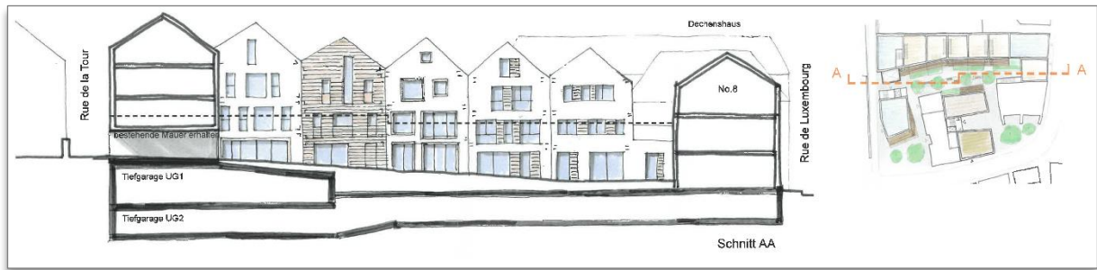
Abb. 10: Schnitt entlang der Reihenhäuser zur Darstellung der maximale Gebäudehöhen, sodass diese sich in den Bestand integrieren. Quelle: gap 2018
