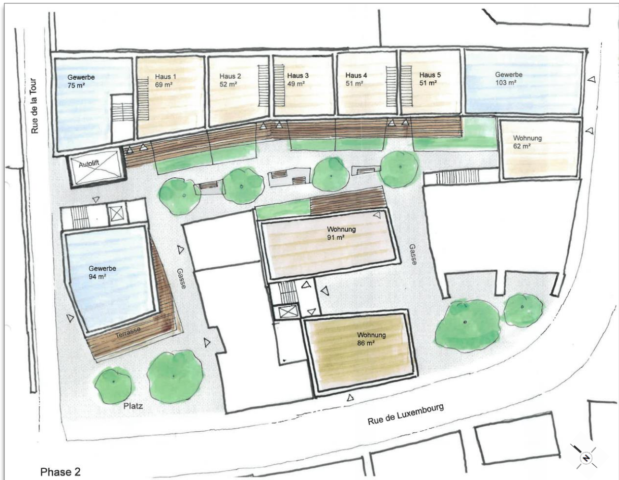
Abb. 9: Grundriss und beabsichtige Nutzungen innerhalb des Plangebietes (ohne Maßstab). Quelle: gap 2018, o.M.
