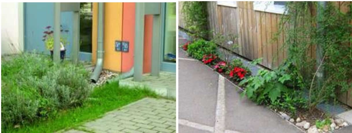
Abbildung 7: Beispiele dezentrale Regenwasserversickerung
