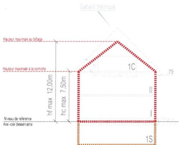
Figure 1 - Coupe-type t2 / gabarit théorique
