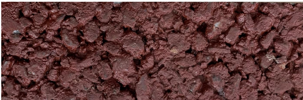
Image 4 : Enrobé rouge produit avec un bitume synthétique avec un pigment à base d'oxyde de fer III
