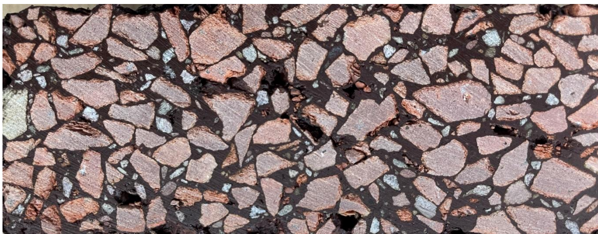
Image 1 : Coupe transversale d'un enrobé rouge avec des granulats conformes
