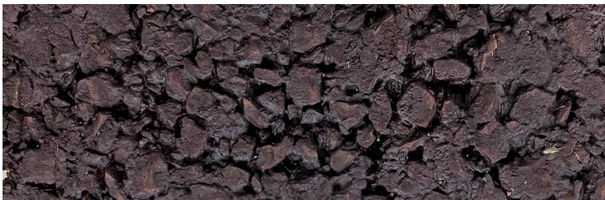
Image 3 : Enrobé rouge produit avec un bitume routier classique avec un pigment à base d'oxyde de fer III
