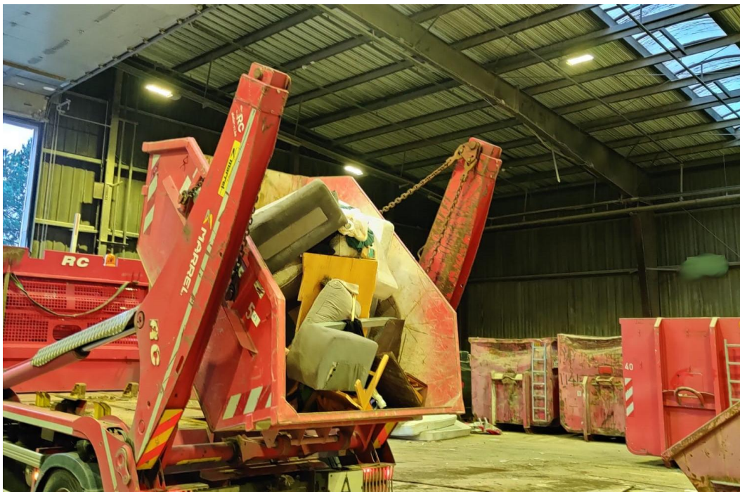
Abbildung 5 : Abkippen der Anlieferung von der MVA.
